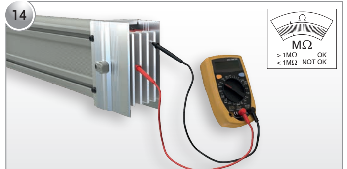
İşlemin uygulanmasından en az 24 saat sonra izolasyon direnç testi uygulanmalıdır.
